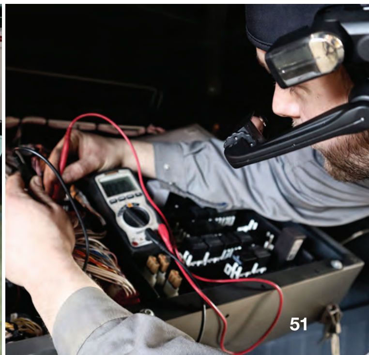
► Pametnim naočalama upravlja se glasovnim naredbama pa serviser ima slobodne ruke za rad na vozilu.
